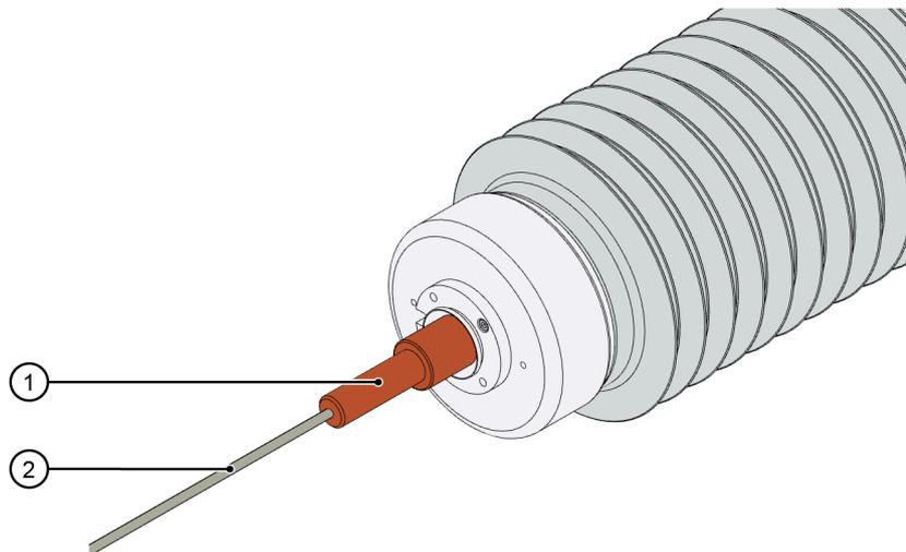
Abb. 15: Lösbaren Leiterbolzen montieren
