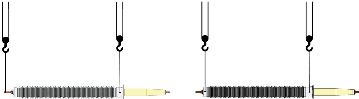
**Abb. 6: Anschlagen mit zwei Hebezeugen (Beispieldarstellung)**
