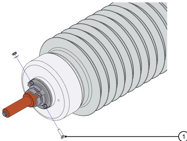
**Abb. 8: Seilbolzen / lösbaren Leiterbolzen demontieren (1)**
