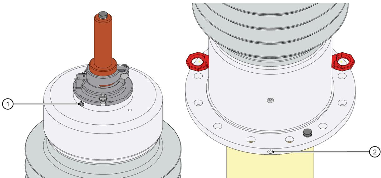
Abb. 25: Entlüftungsschrauben
