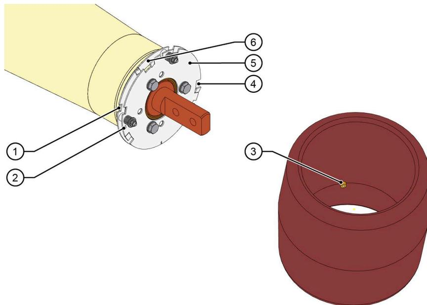
Abb. 13: Aufbau einer Elektrodenhalterung (hier beispielhaft mit beweglicher innerer Scheibe)
