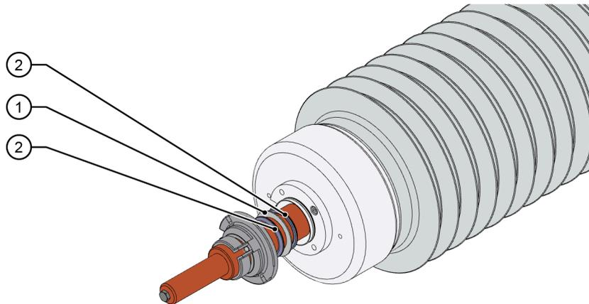
**Abb. 10: Seilbolzen / lösbaren Leiterbolzen demontieren (3)**
