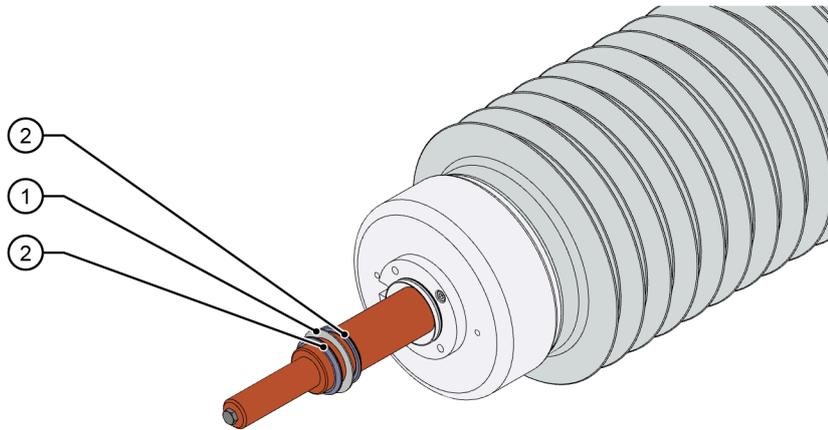
**Abb. 11: Seilbolzen / lösbaren Leiterbolzen demontieren (4)**
