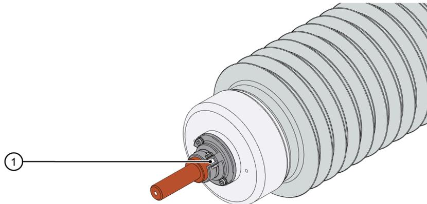
**Abb. 20: Seilbolzen / lösbaren Leiterbolzen montieren (5)**
