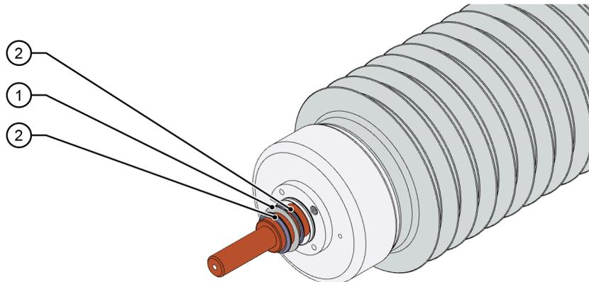
**Abb. 17: Seilbolzen / lösbaren Leiterbolzen montieren (2)**
