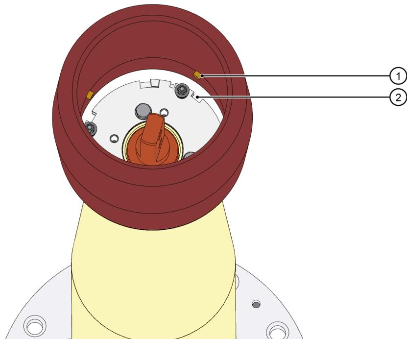
Abb. 21: Elektrode durchschieben
