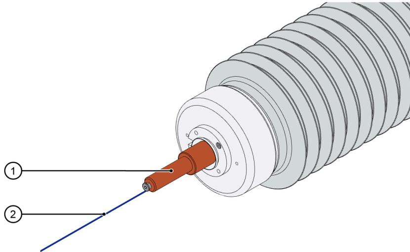
Abb. 14: Seilbolzen montieren
