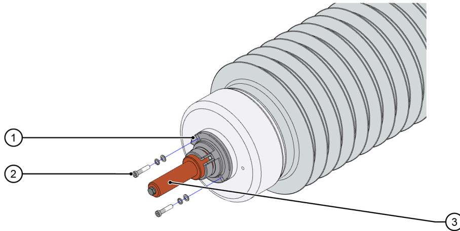
**Abb. 9: Seilbolzen / lösbaren Leiterbolzen demontieren (2)**
