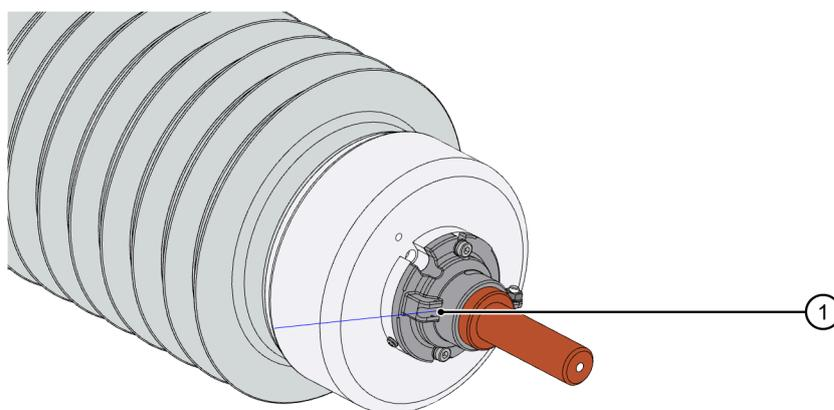
Abb. 22: Seilbolzen / lösbaren Leiterbolzen für Verstiftung vorbereiten
