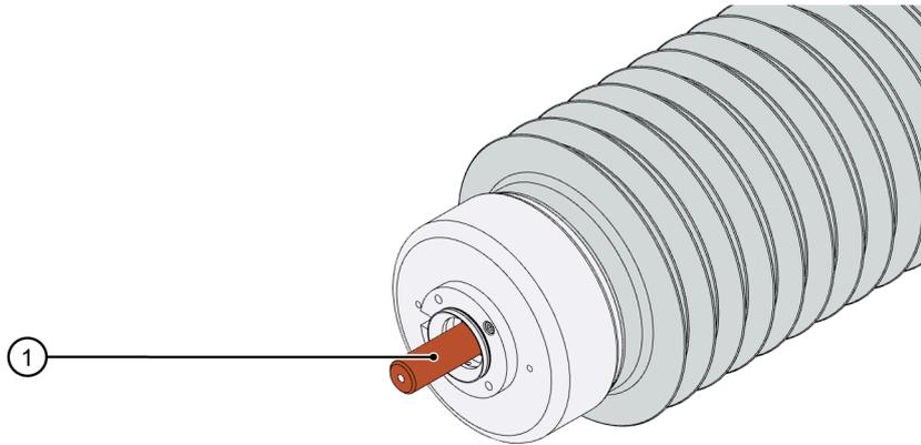
**Abb. 16: Seilbolzen / lösbaeren Leiterbolzen montieren (1)**
