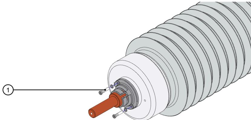
**Abb. 19: Seilbolzen / lösbaren Leiterbolzen montieren (4)**
