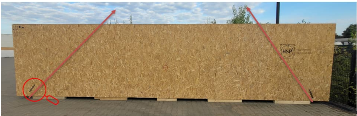
Abbildung 6: Anheben mit Kranschlingen
