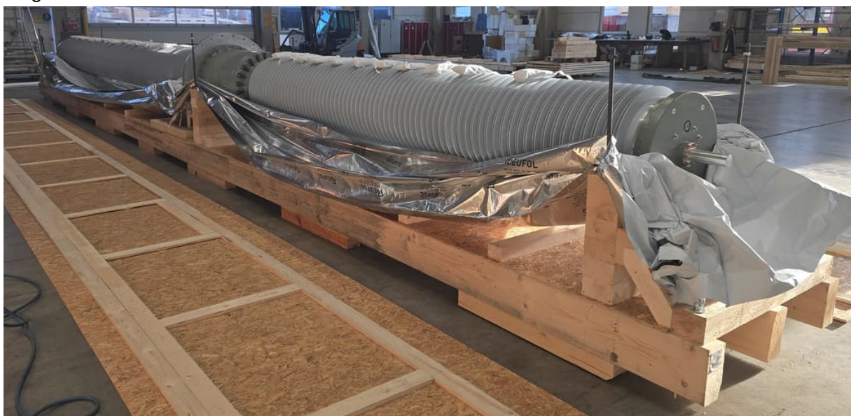
Abbildung 4: Lagerung der Durchführung in der Kiste
